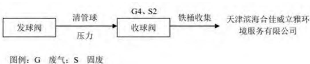
图 2.3-3 清管工艺流程图及排污节点
