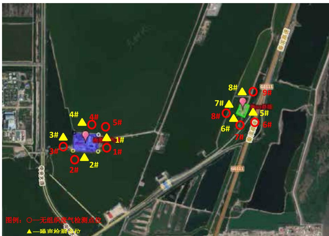
图 8.2-1 注气期无组织废气监测点位、噪声监测点位示意图
