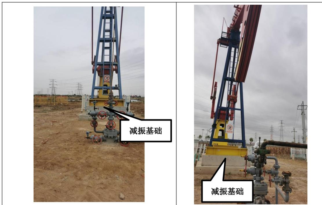
图 6.3-1 本项目运营期抽油机噪声源控制措施现场照片
