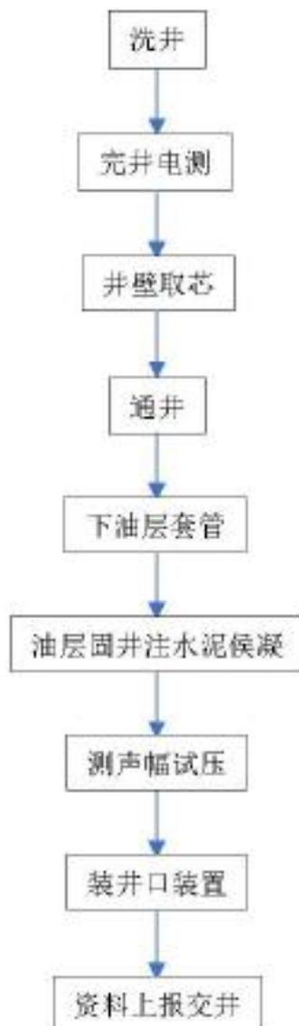
图 2.7-2 完井作业工艺流程
